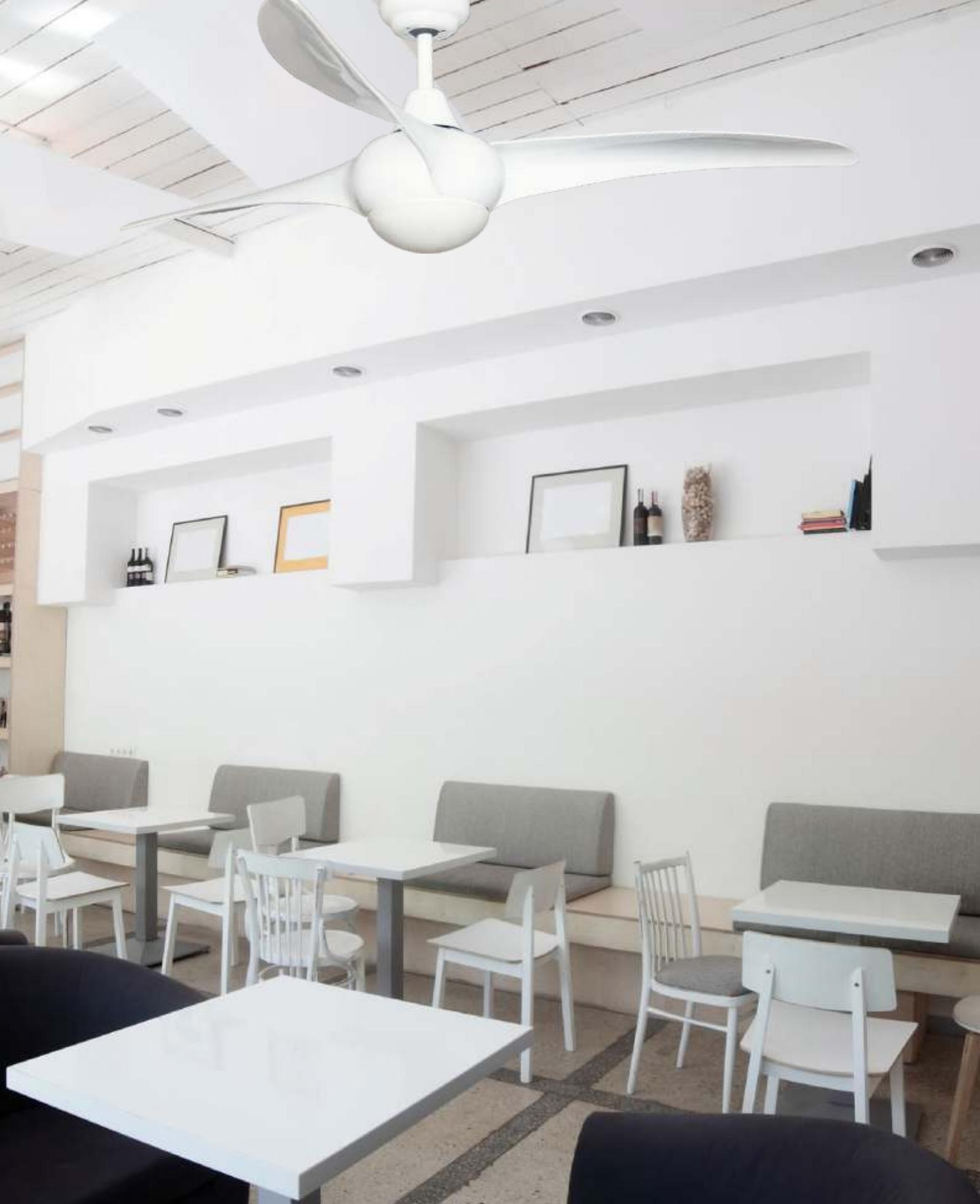
Ventilador de techo con 3 palas de plástico con diseño especial, el diámetro es de 132cm ideal para estancias grandes, el motor es AC de 70W de potencia pudiendo llegar a las 140 R.P.M. el nivel sonoro es de tan solo 45 dB. Se puede instalar en la intemperie como terrazas techadas.
